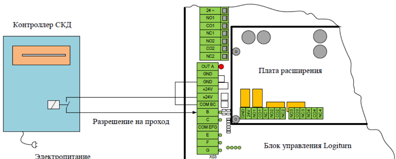
Рисунок 24 - Схема подключения периферийное устройство с релейным выходом
