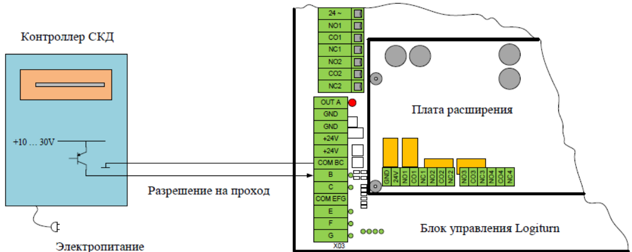
Рисунок 25 - Схема подключения периферийное устройство с выходом типа PNP
