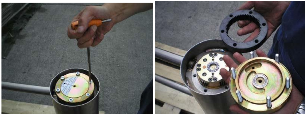
Рисунок 3 - Снятие кулисного диска
