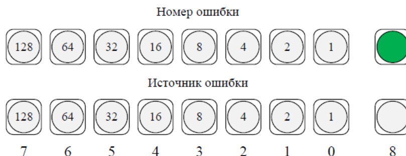
Рисунок 36 - Отображение номера и источника ошибки с помощью светодиодных индикаторов
